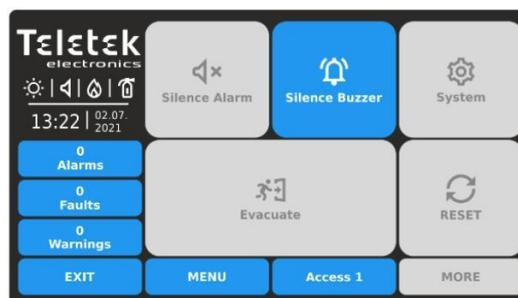
Il livello di accesso 1 è impostato per il funzionamento iniziale.
