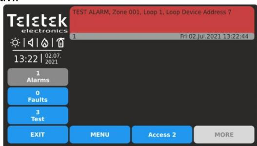
Il test riuscito viene confermato con un messaggio di testo sullo schermo "TEST ALARM" nell'elenco degli eventi di allarme e un singolo suono lungo dal buzzer del pannello. Il numero della zona testata si illumina sul pannello frontale.
