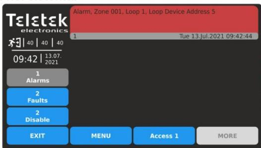
Allarme da un rilevatore di incendio. Il conteggio alla rovescia del tempo per lasciare i locali è in esecuzione. Premere il pulsante MENU o EXIT per tornare alla schermata principale.
