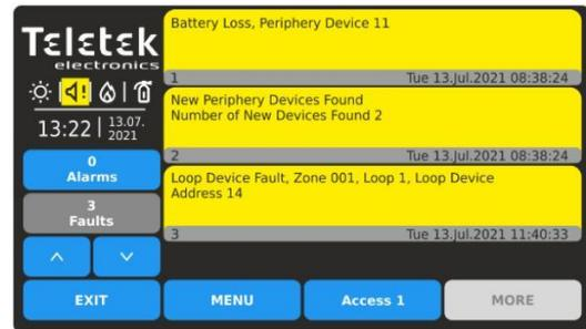
In caso di guasto nel funzionamento del cicalino o delle uscite centrale (suoneria, vigili del fuoco, protezione antincendio), c'è indicazione di un'icona speciale nella sezione di stato. Premere un evento errore per espandere il suo contenuto e rivedere i dettagli per il tipo, numero e/o indirizzo del dispositivo.
