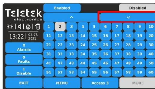
Per rivedere i numeri delle zone fino a 96, premere il pulsante freccia giù. Premere il pulsante freccia su per tornare indietro. Ogni modifica dello stato operativo delle zone viene aggiornata immediatamente nel menu Visualizzazione griglia.
