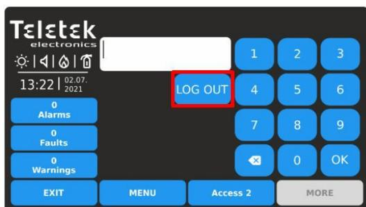
Premere il pulsante ACCESS per cambiare il livello utente. Premere il pulsante LOG OUT per una rapida disconnessione.
