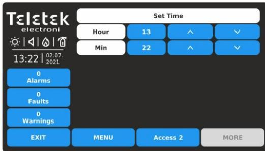
Utilizzare i pulsanti freccia su e giù per impostare l'ora. È anche possibile immettere direttamente le nuove impostazioni utilizzando la tastiera dopo aver selezionato il pulsante numerico per ora/minuti. Utilizzare il pulsante EXIT per tornare ai menu di manutenzione.
