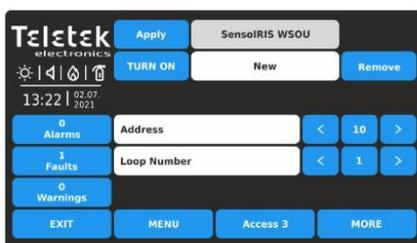
Nuovo dispositivo connesso al loop. Premere il pulsante APPLICA per aggiungerlo configurazione del sistema.
