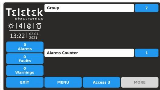
Impostare il numero del GRUPPO da 1 a 250, secondo configurazione del sistema. Nel campo CONTATORE ALLARMI inserire un numero (1-9) di allarmi antincendio, quando dopo aver raggiunto il loro conteggio, l'ingresso verrà attivato. Nota: Il CONTATORE ALLARMI può essere impostato solo per il tipo di evento generale INCENDIO COMUNE.
