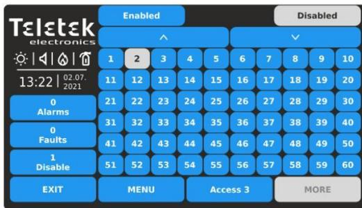
Per primi vengono visualizzati i numeri delle zone da 1 a 60. I numeri delle zone abilitate vengono presentati con pulsante in blu. I numeri delle zone disabilitate vengono presentati con pulsante grigio.
