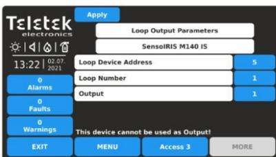
*Nota: I moduli con uscite serie SensoIRIS - MIO-22, MIO-22M, MIO-04, MOUT, MOUT-240, MIMIC - vengono visualizzati con le uscite disponibili. Se il dispositivo è una sirena, la centrale mostrerà solo una uscita e non è programmabile.*
