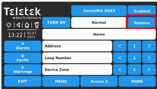
**Nota:** Se dopo l'eliminazione del dispositivo rimosso è comunque collegato fisicamente al loop, la centrale lo troverà e avviserà con i messaggi di errore "Nuovi dispositivi del loop trovati". Per evitare ciò, si consiglia prima di scollegare il dispositivo dal loop e successivamente rimuoverlo dal loop menù dispositivi.
