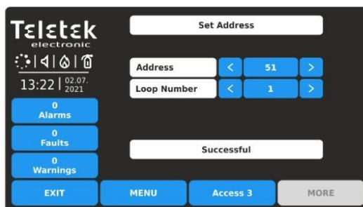
Durante l'impostazione dell'indirizzo il sistema resta inattivo operazione. L'icona di sistema lampeggiante mostra che il processo è in esecuzione.
