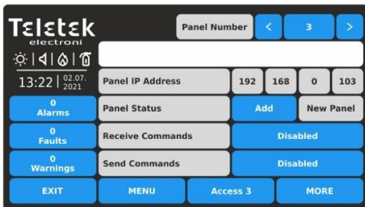
Il nuovo numero di centrale si trova nella configurazione di rete. Premere il pulsante AGGIUNGI. Lo stato cambierà in PRESENTE. Se è stato impostato un nome per questo pannello, verrà visualizzato nel campo di testo. Il passo successivo è abilitare i comandi di controllo "Ricezione" e "Invio" ad altri pannelli. Confermare con il pulsante APPLICA per salvare le impostazioni.
