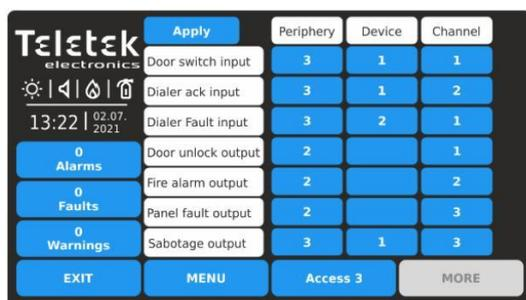
Per la realizzazione del collegamento tra pannello iRIS4 e il pannello FAT/FBF vengono utilizzati due moduli MIO-22 e tre delle uscite programmabili della centrale iRIS4.
