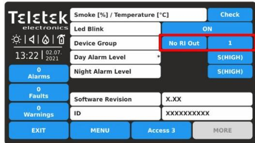
Questo è un campo per inserire un numero di gruppo (da 1 a 100) per il rilevatore. In caso di allarme incendio, il rilevatore farà attivare l'RI per quel numero di gruppo. Impostare "0" se nessun gruppo per il controllo RI è richiesto per rilevatore: l'opzione RI OUT non è disponibile. In un gruppo di dispositivi possono essere inclusi uno o più altri rilevatori per il controllo di un singolo indicatore remoto. Questa opzione è chiamata controllo RI.
