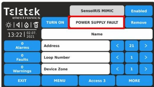
Il modulo SensolRIS MIMIC deve essere acceso da un alimentatore esterno 12-24VDC. In caso di guasto dell'alimentazione esterna, sullo stato verrà visualizzato il messaggio "Guasto alimentazione".
