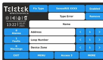
Dispositivo di tipo diverso trovato all'indirizzo. Premere TYPE FIX per correggere o RIMUOVI
