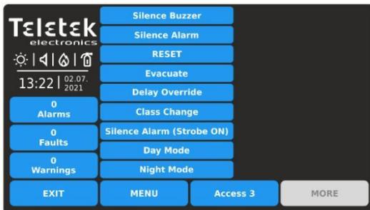
Premere il pulsante attivo per il rispettivo evento di azione. L'evento di azione selezionato viene automaticamente impostato in sezione FUNZIONE.
