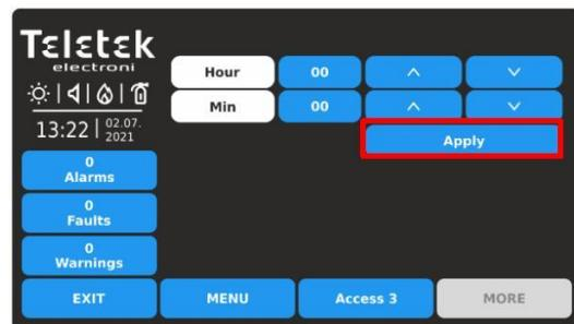
Utilizzare le frecce o impostare direttamente l'ora tramite il pulsante numerico e tastiera virtuale. Confermare l'ora impostata con APPLICA pulsante. Il pannello tornerà alle impostazioni di pianificazione temporale sullo schermo poiché la nuova ora viene impostata direttamente per il rispettivo giorno della settimana.
