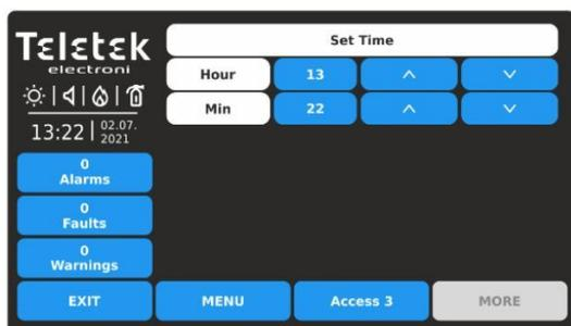
Utilizzare i pulsanti freccia su e giù per impostare l'ora. È anche possibile inserire direttamente le nuove impostazioni utilizzando la tastiera dopo aver selezionato il pulsante numerico per ore/minuti.
