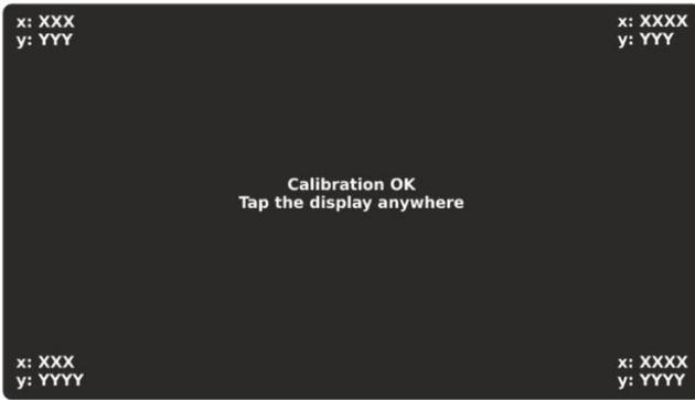
5. Viene visualizzato il messaggio di calibrazione riuscita. Premere lo schermo in un punto qualsiasi per tornare al menu DISPLAY.
