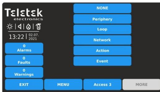
Per impostazione predefinita, tutte le uscite sono impostate come tipo NONE. Utilizzare i pulsanti freccia o inserire un numero di uscita da 1 a 250. Premere il pulsante attivo per selezionare l'uscita tipo (NESSUNO). Nota: il contenuto dello schermo potrebbe cambiare in base alle impostazioni per Tipo di output.
