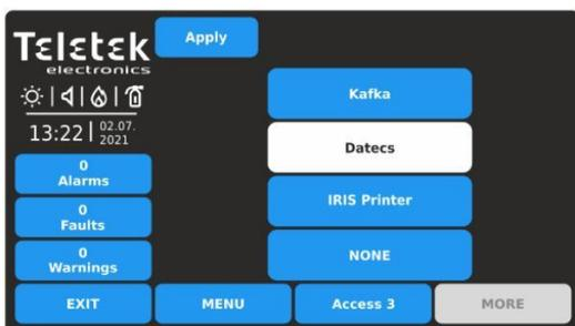
La centrale antincendio iRIS4 può funzionare con seguenti tipi di stampanti termiche: Tipo Canon: Kafka e Datecs - Sono compatti stampanti termiche modello autonomo. Stampante IRIS - La stampante è situata in un metallo resistente box adatto alla realizzazione di struttura modulare.
