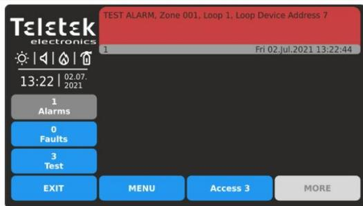
L'esito positivo del test viene confermato con un messaggio di testo sullo schermo "TEST ALARM" nell'elenco degli eventi di allarme e un singolo suono lungo dal cicalino della centrale. Il numero della zona testata si illumina sulla parte anteriore pannello.
