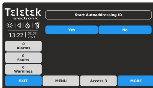
Per avviare l'indirizzamento automatico tramite numeri ID nel numero di loop selezionato, premere il pulsante "Avvia ID indirizzamento automatico".
