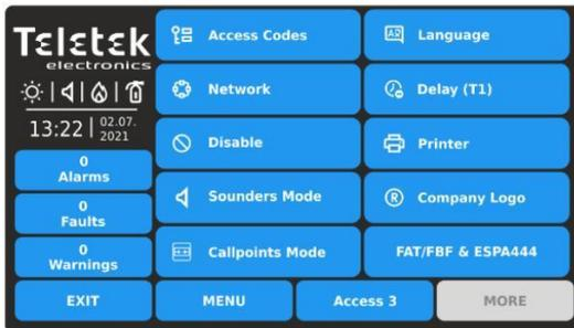
Il menu del pannello principale include un elenco con il massimo parametri importanti per il funzionamento del pannello iRIS4.
