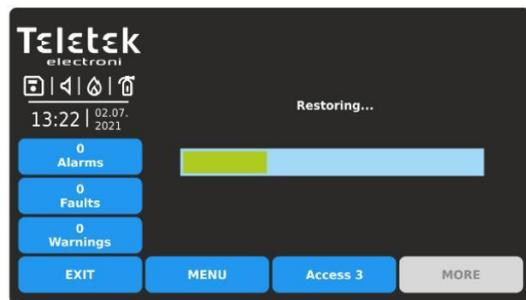
Una volta avviato il processo di ripristino delle impostazioni predefinite non può essere interrotto o annullato. Una volta completato il processo, la centrale tornerà alla schermata principale al livello di accesso 3.
