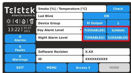
Se la parte del fumo ottico è disabilitata e anche la parte della temperatura è impostata su disabilitata, l'impostazione per il fumo ottico cambierà automaticamente in abilitata a un livello di sensibilità elevato.
