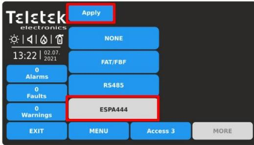
Selezionare il protocollo di comunicazione ESPA444 e confermare con il pulsante APPLICA. Non è prevista alcuna ulteriore programmazione per il protocollo seriale ESPA necessario.
