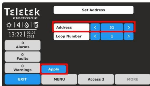
Il sistema mostra automaticamente il primo indirizzo nel sistema. Se l'indirizzo è assegnato, verrà visualizzato il nome del dispositivo. Puoi controllare la posizione del dispositivo assegnato a questo indirizzo premendo il pulsante ACCENSIONE: i LED del dispositivo si accenderanno in modo permanente. La successiva pressione dello stesso pulsante si spegnerà il LED.
