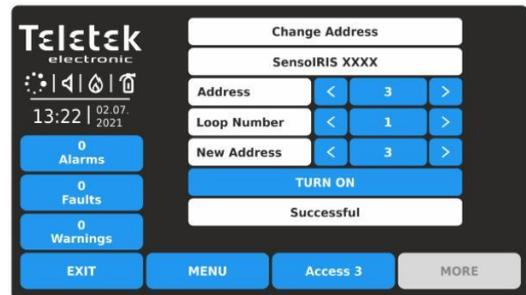
Se la modifica dell'indirizzo va a buon fine, sullo schermo viene visualizzato il messaggio RIUSCITO. Il pannello entra in modalità reset. È possibile procedere con la modifica di un altro indirizzo o uscire premendo il tasto EXIT.
