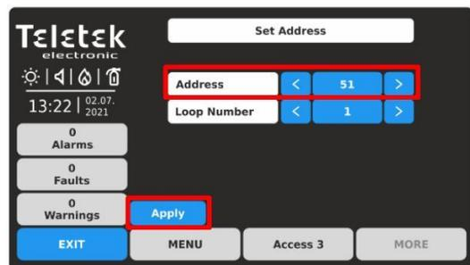
Il sistema mostra automaticamente il primo indirizzo nel sistema. Se l'indirizzo è assegnato, il pannello visualizzerà il dispositivo con il suo nome di sistema. È possibile verificare la posizione del dispositivo assegnato a questo indirizzo premendo il pulsante ACCENSIONE: i LED del dispositivo si accenderanno in modo fisso. La successiva pressione dello stesso pulsante spegnerà i LED.
