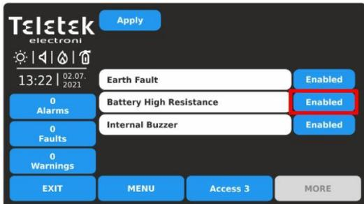
Per impostazione predefinita, l'opzione BATTERIA ALTA RESISTENZA è disabilitata e il CICALINO INTERNO è abilitato. Ogni pressione del pulsante Abilita/Disabilita modifica lo stato. Confermare la nuova impostazione premendo il pulsante APPLICA nella parte superiore dello schermo. Per tornare ai menu del pannello, premere il pulsante ESCI.
