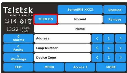
Il pulsante accende i LED (o la segnalazione acustica per WSOU, WSOU IS, BSOU, BSOU IS, CSOU, CSOU IS) del dispositivo durante il controllo del suo luogo di installazione. Quando è in stato ON, il LED del dispositivo si accende (le sirene WSOU, WSOU IS, BSOU e BSOU IS sono attivate). Dopo essere usciti dal menu del dispositivo, il pulsante passa automaticamente allo stato OFF e il LED si spegne.
