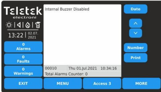
Gli eventi vengono presentati con informazioni dettagliate su tipo, zona, loop e numero del dispositivo. Nel caso in cui la centrale sia connessa in rete, il messaggio contiene anche informazioni sul numero e sul nome della centrale nel sistema.
