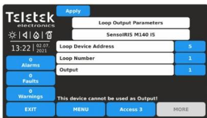
**Nota:** i moduli con uscite della serie SensolRIS - MIO-22, MIO-22M, MIO-04, MOUT, MOUT-240, MIMIC, MiniOUT - vengono visualizzati con le uscite disponibili. Se il dispositivo è una sirena, la centrale ne mostrerà una sola e non sarà programmabile. I seguenti messaggi potrebbero apparire sullo schermo per avvisare l'installatore di eventuali problemi:
