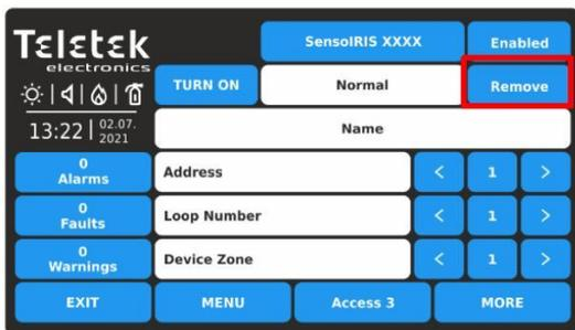
**Note:** Se, dopo l'eliminazione, il dispositivo rimosso è ancora fisicamente connesso al loop, la centrale lo rileverà e avvierà con il messaggio di errore "Nuovi dispositivi loop trovati". Per evitare ciò, si consiglia di scollegare prima il dispositivo dal loop e poi di rimuoverlo dal menu dei dispositivi loop.
