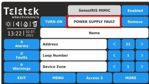
Il modulo SensolRIS MIMIC deve essere alimentato da un alimentatore esterno da 12-24 V CC. In caso di interruzione dell'alimentazione esterna, il messaggio di errore "Errore alimentatore" apparirà sul campo di stato del dispositivo.
