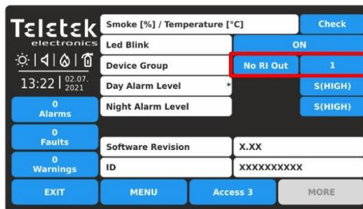
Questo è un campo per inserire un numero di gruppo (da 1 a 100) per il rilevatore. In caso di allarme incendio, il rilevatore attiverà l'RI per quel numero di gruppo. Impostare "0" se non è applicabile o richiesto alcun gruppo di dispositivi per il controllo RI per il rilevatore: l'opzione RI OUT non è disponibile. In un gruppo di dispositivi è possibile includere uno o più rilevatori per il controllo di un singolo indicatore remoto. Questa opzione è chiamata controllo RI.
