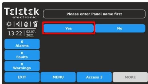
Premere il pulsante Sì per inserire il nome del pannello. Nota: il nome verrà impostato automaticamente anche nel menu Impostazioni di rete, senza necessità di conferma.
