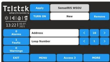
Nuovo dispositivo connesso al loop. Premi il pulsante APPLICA per aggiungerlo alla configurazione del sistema.
