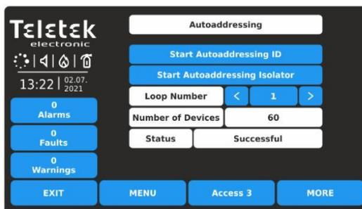
L'icona di sistema lampeggiante indica che il processo è in esecuzione. Nel campo NUMERO DI DISPOSITIVI viene visualizzato il numero impostato di dispositivi indirizzati al momento.
