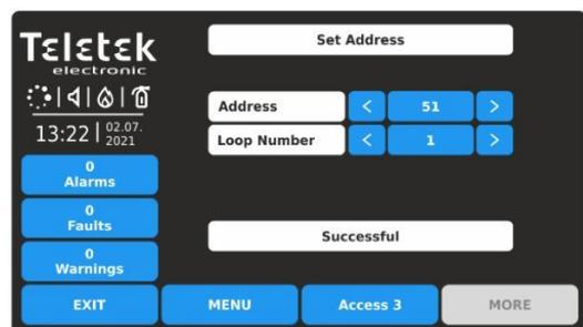
Durante l'impostazione dell'indirizzo, il sistema è inattivo. L'icona di sistema lampeggiante indica che il processo è in esecuzione.
