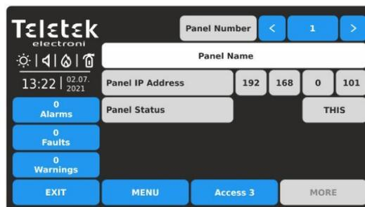
Il nuovo numero di pannello è stato trovato nella configurazione di rete. Premere il pulsante AGGIUNGI. Lo stato cambierà in PRESENTE. Se è stato impostato un nome per questo pannello, questo verrà visualizzato nel campo di testo. Il passaggio successivo consiste nell'abilitare i comandi di controllo "Ricezione" e "Invio" ad altri pannelli. Confermare con il pulsante APPLICA per salvare le impostazioni.
