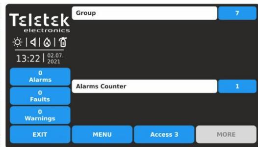
Impostare il numero di GRUPPO da 1 a 250, in base alla configurazione del sistema. Nel campo CONTATORE ALLARMI inserire un numero (da 1 a 9) di allarmi incendio registrati; al raggiungimento del conteggio, l'ingresso verrà attivato. Nota: il campo CONTATORE ALLARMI è impostato solo per l'evento generale di tipo INCENDIO COMUNE.
