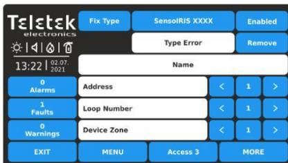
Dispositivo di tipo diverso trovato all'indirizzo. Premere il pulsante CORREGGI TIPO per correggere o il pulsante RIMUOVI per eliminare.
