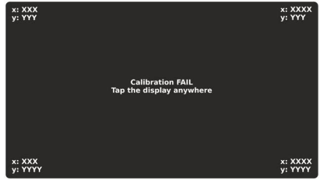
Se la calibrazione non riesce, viene visualizzato un messaggio di errore. In tal caso, si consiglia di eseguire nuovamente la calibrazione. Premere un punto qualsiasi dello schermo per tornare al menu DISPLAY.
